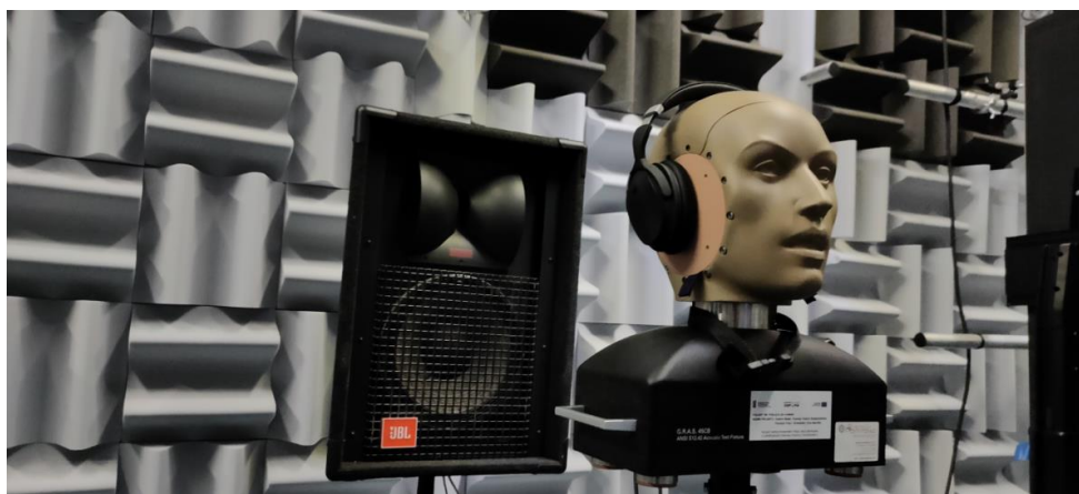
Zadanie 1.ZS.10. Pomiary tłumienia realizowane w komorze akustycznej TSB
