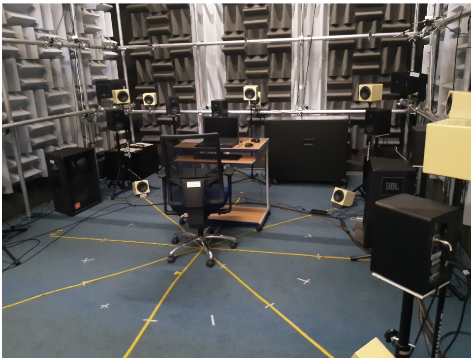
Rys. 1. Stanowisko do laboratoryjnych badań uciążliwości hałasu turbin wiatrowych
