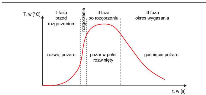
Rys. 2. Krzywa rozwoju pożaru w pomieszczeniu
