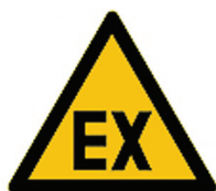
Rys. 2. Oznakowanie miejsc zagrożonych atmosferą wybuchową
