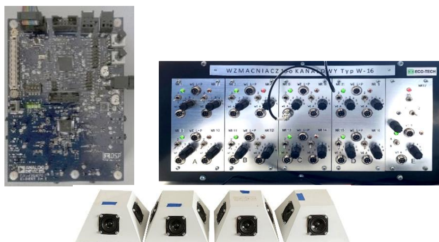
Zadanie 2.SP.05. Model źródła maskującego dźwięki mowy (generator cyfrowy, wzmacniacz mocy, kolumny dźwiękowe)
