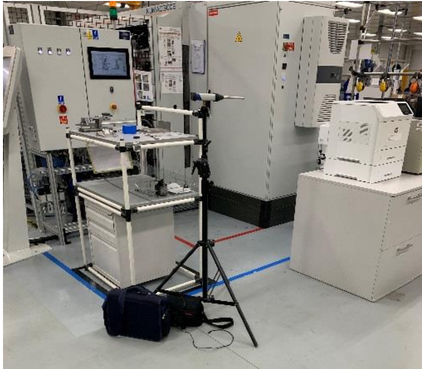
Projekt III.PB.06. Pomiar na stanowisku pracy w fabryce wyrobów gumowych
