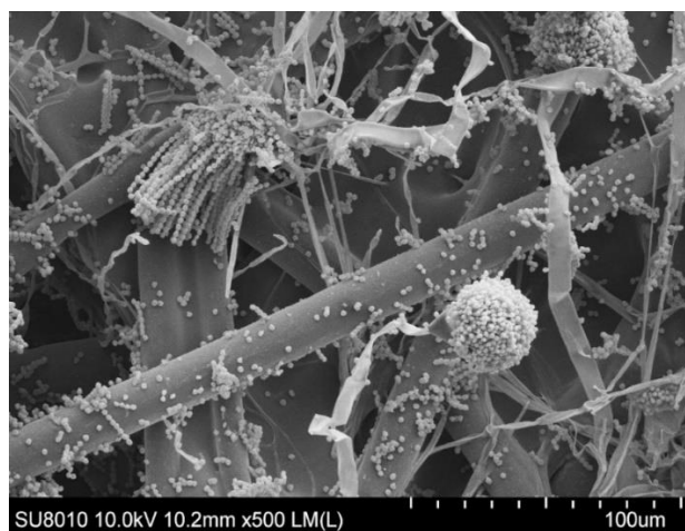
Zadanie 2.SP.16. Aspergillus spp. na włókninie filtracyjnej z układu klimatyzacyjnego samochodu osobowego
