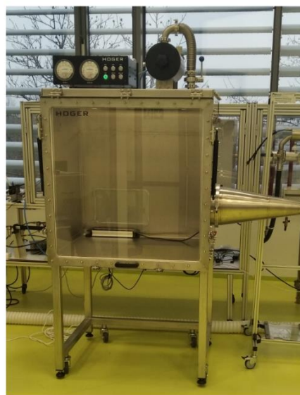
Zadanie 2.SP.12. Komora badawcza do emisji nanoobjektów z materiałów pokrytych warstwami funkcjonalnymi
