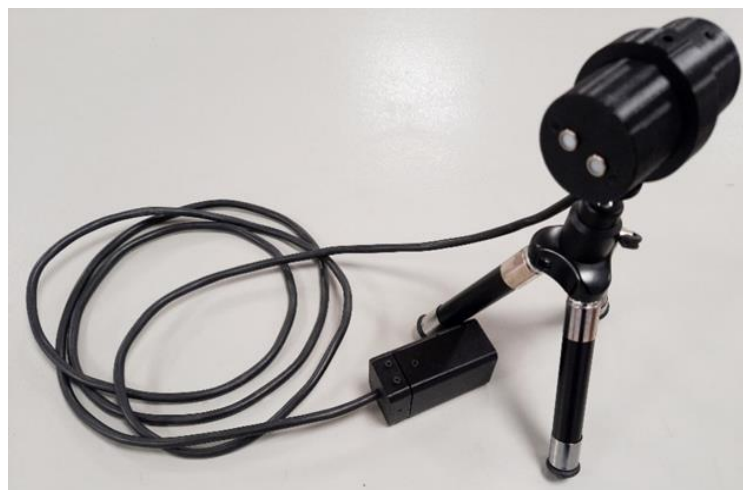
Zadanie 2.SP.07. Model detektora pomiarowego na statywie z modułem zasilającym
