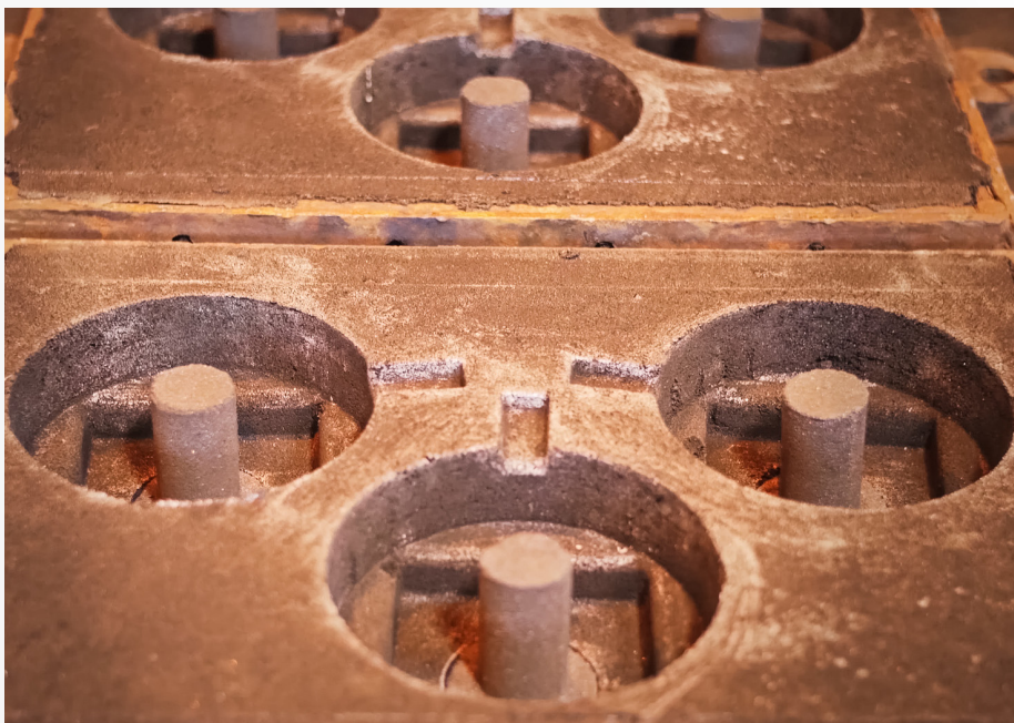
W odlewniach źródłem FRKK są m.in. prace związane z wytwarzaniem form odlewniczych (fot. denpomo/Bigstockphoto) In foundries, the sources of RCS are, among others works related to the production of foundry molds (photo: denpomo/Bigstockphoto)
