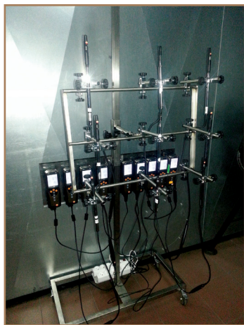
Rys. 2. Widok ogólny modułu do pomiaru prędkości przepływu powietrza, temperatury i wilgotności względnej powietrza w otoczeniu źródła emisji w komorze
