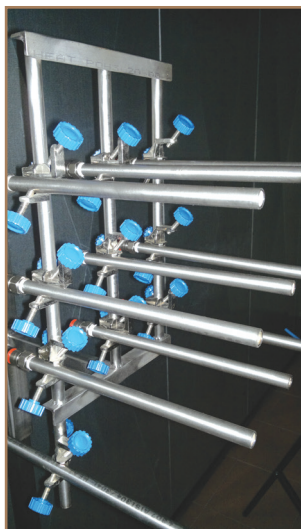
Rys. 7. Widok ogólny zestawu sond do poboru próbek powietrza
