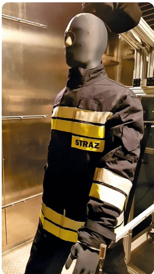
Fot. Przykład manekina termicznego Newton z włączoną funkcją chodzenia
