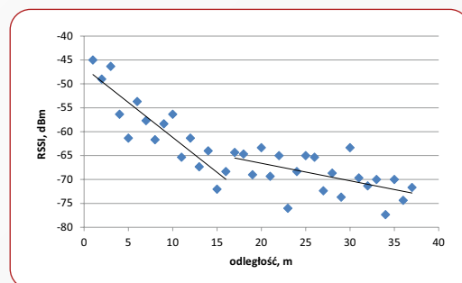
Rys. 6. Wyniki pomiarów mocy odbieranego sygnału podczas badań układów opracowanych modeli nadajnika i odbiornika
