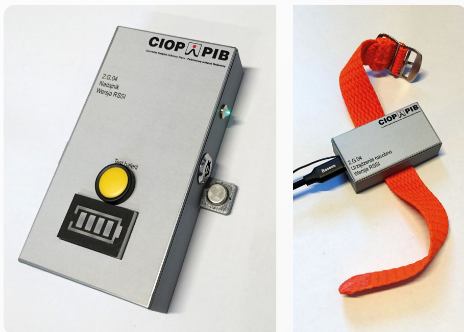
Rys. 5. Modele nadajnika (po lewej stronie) i odbiornika (po prawej stronie) systemu bazującego na pomiarze mocy sygnału radiowego, gdzie nadajnik jest urządzeniem Bluetooth klasy pierwszej
