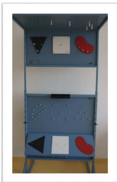
Rys. 14. Tablica pomiarowa wyposażona w 25 białych nakrętek i 2 zaciski do regulacji wysokości
