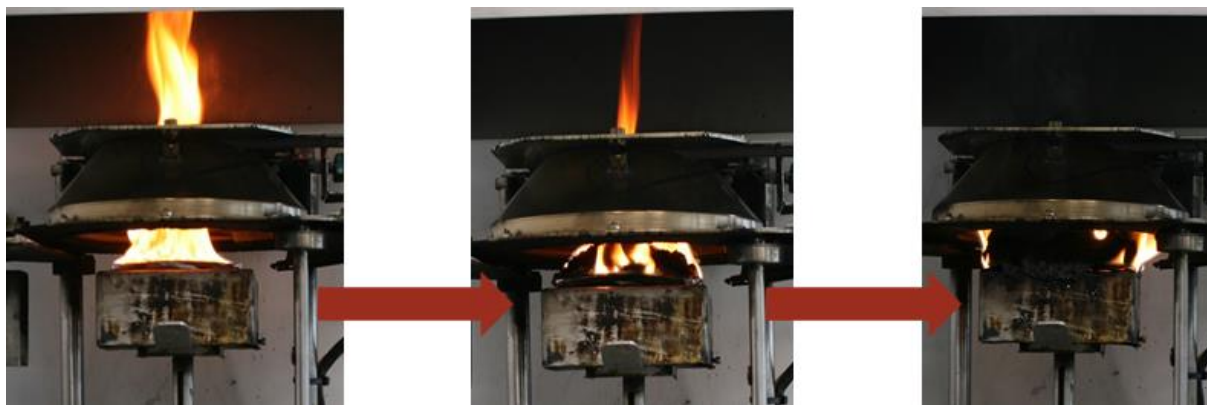
Rys. 2. Przebieg badania przeprowadzonego z wykorzystaniem kalorymetru stożkowego dla próbki tworzywa polimerowego zawierającej uniepalniacz intumescent (fot. własna CIOP-PIB)
