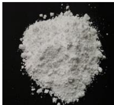
Rys. 4. Wzór strukturalny i wygląd komercyjnego uniepalniacza APP (fot. własna CIOP-PIB)
