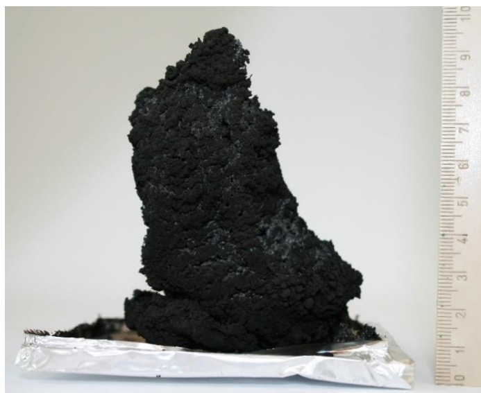
Rys. 3. Przykładowy wygląd próbki zawierającej uniepalniacz intumescent po badaniu przeprowadzonym z wykorzystaniem kalorymetru stożkowego (fot. własna CIOP-PIB)
