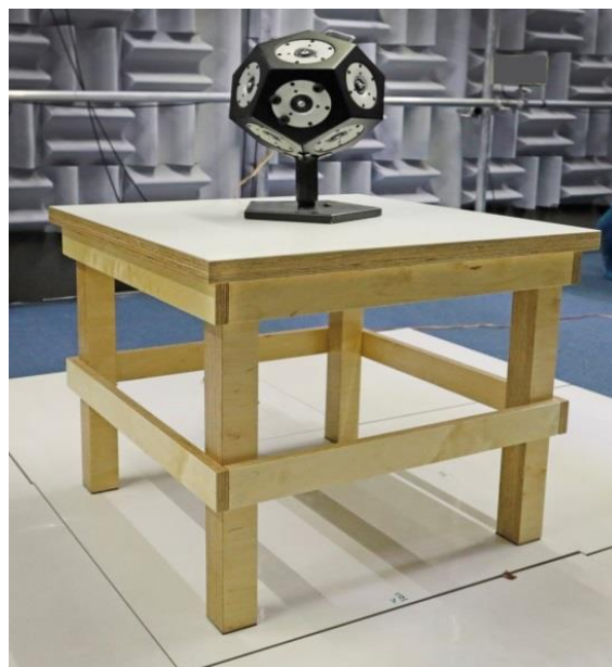
Rys. 2. Stolik pomiarowy wg serii norm PN-EN ISO 11200
