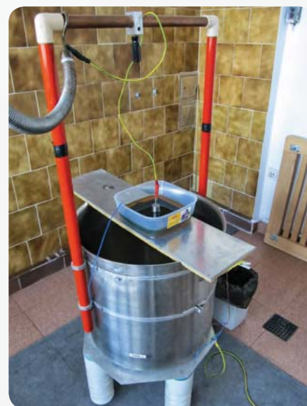
Fot. 3. Widok stanowiska do badań wytrzymałości elektrycznej próbki chodnika elektroizolacyjnego
