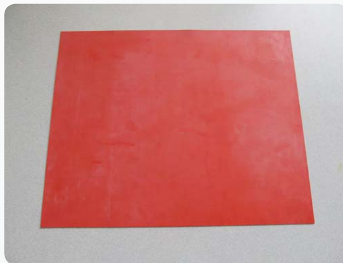
Fot. 2. Widok płachty elektroizolacyjnej klasy 1.
