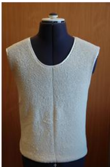
Rys. 2. Trójwarstwowa kamizelka o budowie kanałowej wypełniona makrokapsułkami PCM - zgłoszenie patentowe nr P-396551 (praca badawcza własna) [17]
