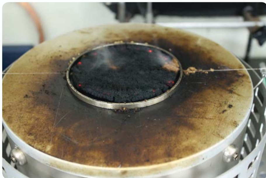
Fot. 2. Przykład widocznego wystąpienia zjawiska żarzenia będącego warunkiem wystarczającym do stwierdzenia zapłonu Photo 2. Example of optically visible incandescent points – sufficient conditions for determination the ignition at test temperature
