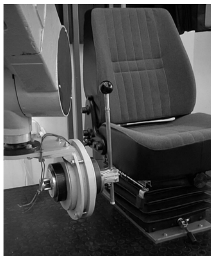
Rys. 3. Fotel operatora (obok dźwignia sterownicza o zmiennej długości)
