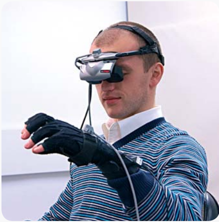
Fot. Elementy systemu rzeczywistości wirtualnej: info-rękawica oraz info-helm
