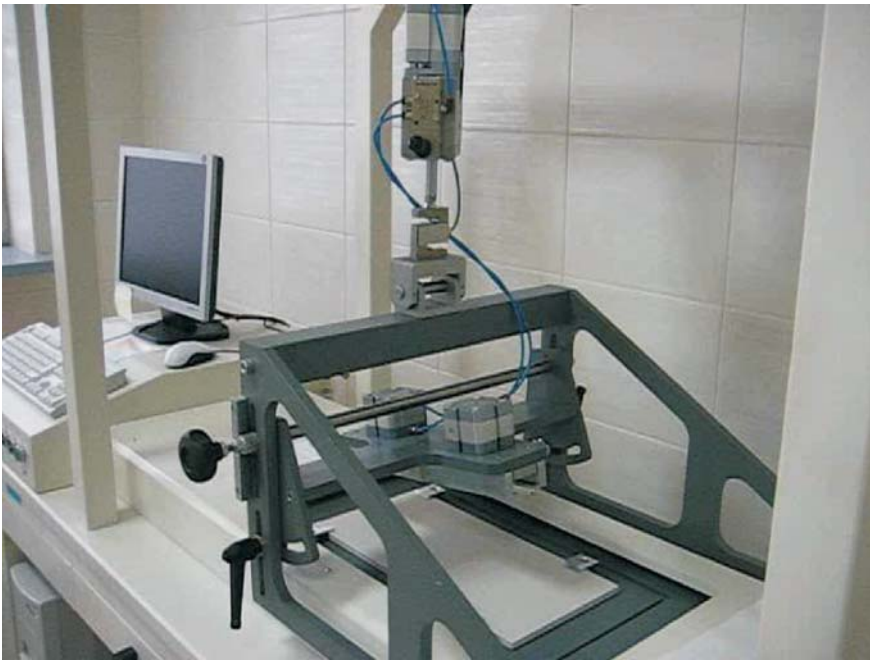
Fot. Stanowisko do badania odporności obuwia na poślizg zbudowane w Centralnym Instytucie Ochrony Pracy – Państwowym Instytucie Badawczym
