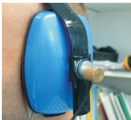
Fot. 2. Przykład mocowania mikrofonu do czaszy nauszników przeciwhałasowych
